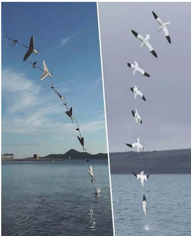
图8 英国帝国理工学院研制的 AquaMav（塘鹅）跨介质飞行器样机（左图：样机入水照片；右图：真实塘鹅入水照片）
