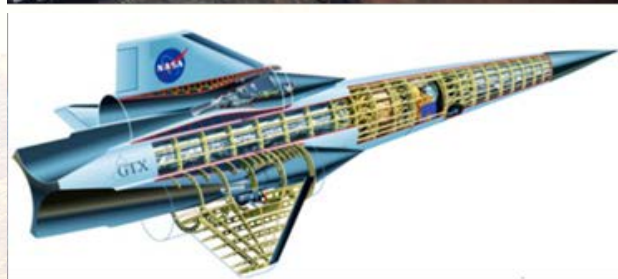
图4 “螺旋”两级入轨系统概念(上)与 GTX 飞行器概念(下)
