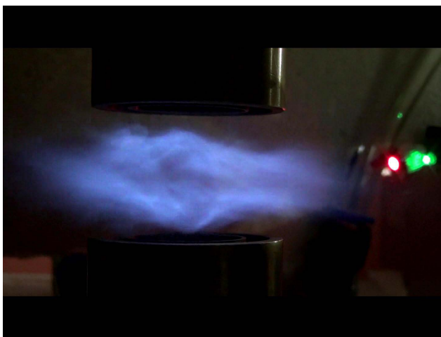
图 5 微重力下的对冲火焰
