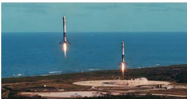
图2 重型猎鹰火箭助推器垂直回收
