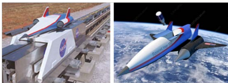
图 5 NASA 的磁悬浮发射试验装置（左）和 MagLifter 概念设想（右）
