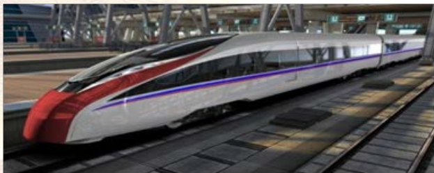
图 1 高速列车的流线头型
