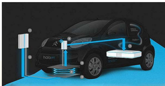
图 3 目前新能源汽车无线充电系统示意图
