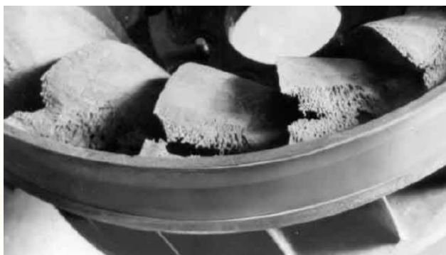
水轮机叶片典型的空蚀结构破坏图 (图片来源: 参考文献 4)
